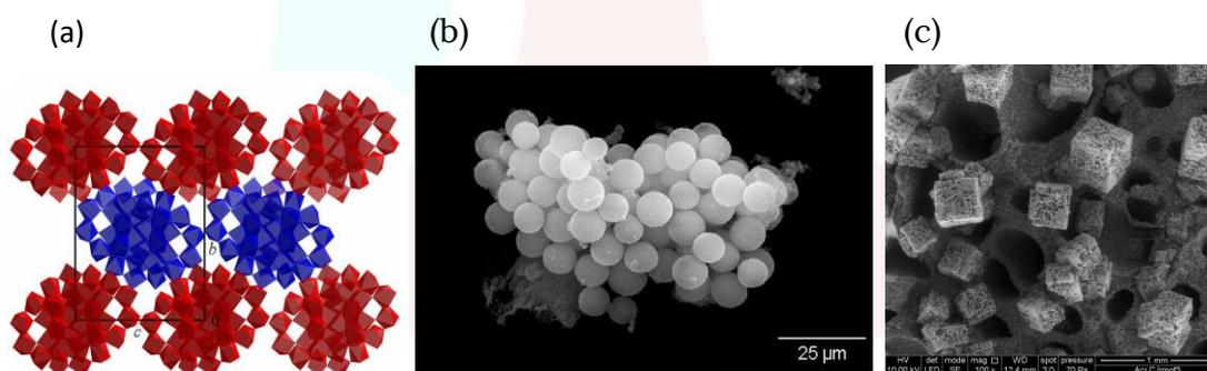
**Figura 4.** a) Red metal-orgánica asistido por enlaces de hidrógeno. b) micrografías de microscopía de barrido de carbones hidrofílicos. c) materiales híbridos formado por hidrogeles macroporosos y cristales de MOF-5. Imágenes propias.
