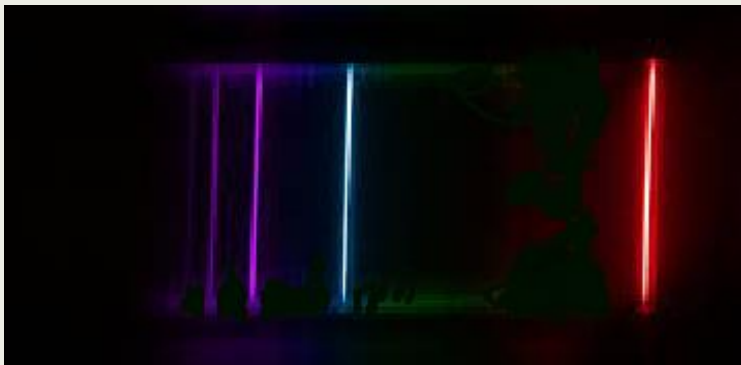
Serie de Balmer del Hidrógeno
